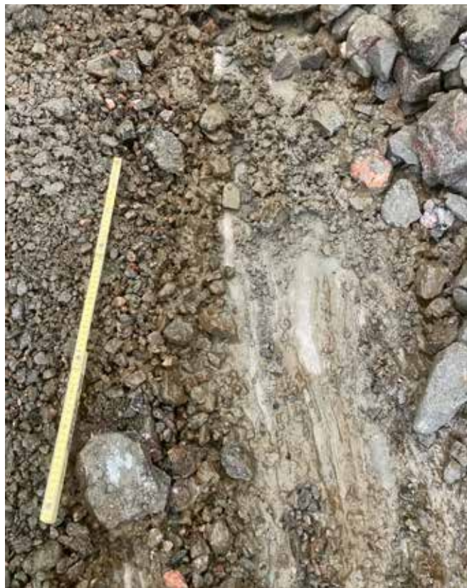
Figur 2. Till vänster: "Välpackad" tätjord frilagd efter 4,5 år. Till höger: Brun "gegga" i nedströms grovfilter. Här hamnade en betydande del av tätjordens eroderade finmaterial. Foto: Johan Lagerlund
