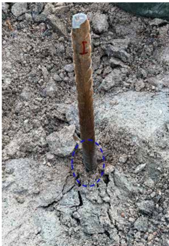
Figur 1. Foton på provade bergförankringar. Den vänstra bilden visar en slät stång som gått till brott i injektionsbruket. Den högra bilden visar ett kamstål som gått till brott i stålet, den blå cirkeln visar delen av förankringslängden som dragits upp. Båda bilderna visar tydligt att den del som varit ingjuten är i väldigt gott skick. Foto: Peter Lundqvist, Vattenfall
