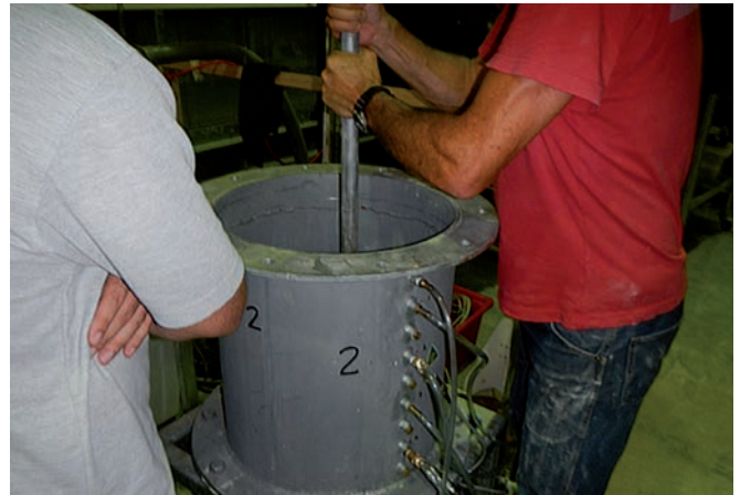
Bild 3 Iläggning och pågående packning och iordningställande av testmaterial vid WRL inom University of New South Wales.
