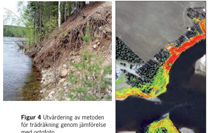
Figur 3. Figur till höger visar GIS-analysens resultat över riskzoner för skred/ras. Valideringen av analysresultaten mot bilder tagna vid tidigare inventering visar på att hittade skred/ras ligger inom de högsta riskzonerna. Grön punkt på bild till höger visar ungefärlig plats för fotot till vänster. FOTO: Sweco
