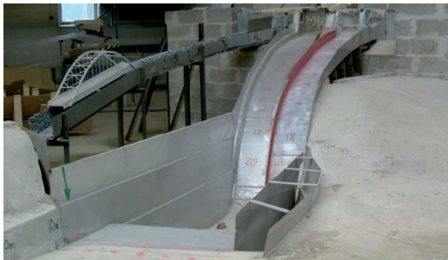
Delar av den hydrauliska modellen av Höljes. På bilden syns utskov och energiomvandlare.
